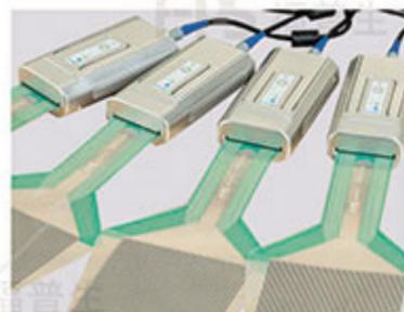
多通道薄膜压力测量仪
