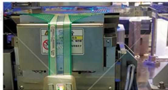
丝网印刷刮刀平衡度测量
