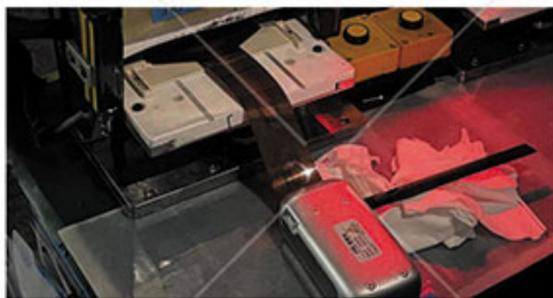
锂电池二封压头压力分布测量
