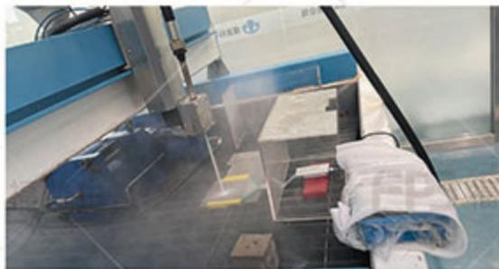
液体喷射压力分布测量
